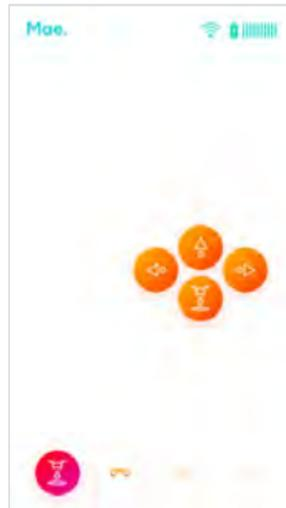
*Le bouton arrêt d'urgence coupe les moteurs en cas de perte de contrôle du drone en mouvement, l'atterrissage lui permet de se poser en douceur.*
